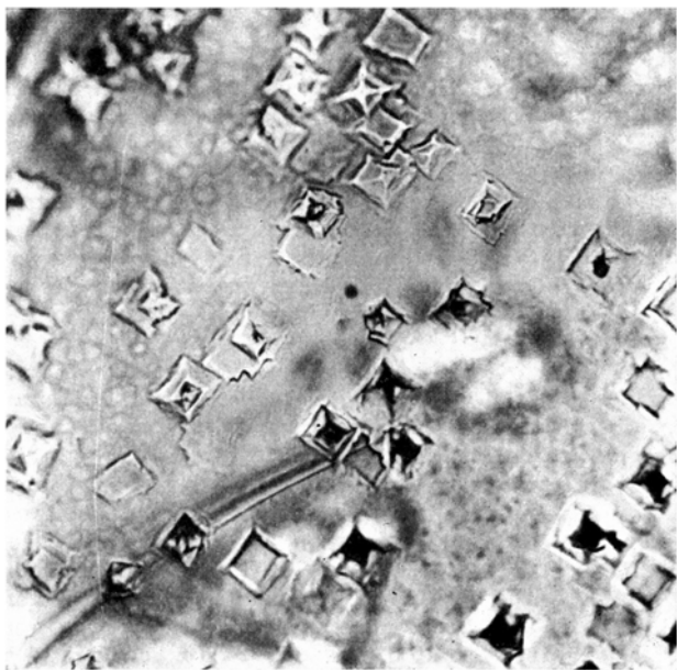
Abb. 2. Orientierte Aufwachsung von \text{NH}_4\text{J} auf (001) von Talk.
